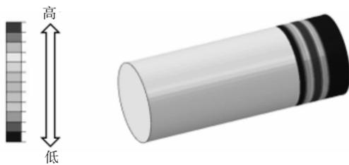
图11 接头外壁挤压应力分布
