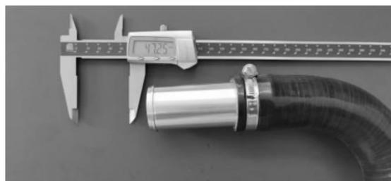
图6 拧紧力矩-硅胶管外径试验
