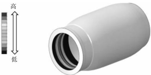
图12 硅胶管内壁挤压应力分布
